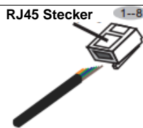
Abbildung 3.21 Isolierschicht abisolieren und an RJ45-Stecker anschließen
